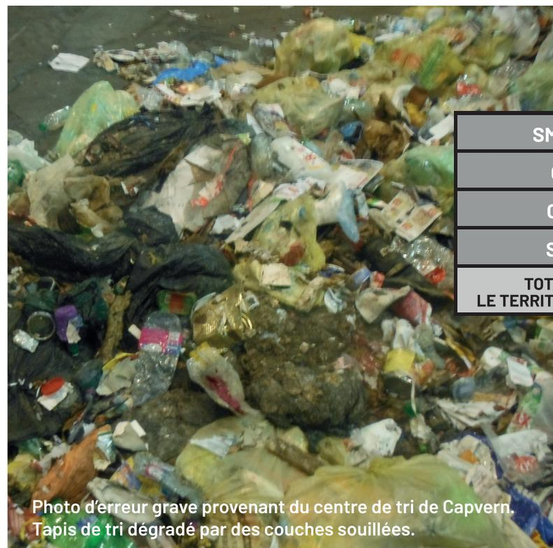
Photo d'erreur grave provenant du centre de tri de Capvern. Tapis de tri dégradé par des couches souillées.
